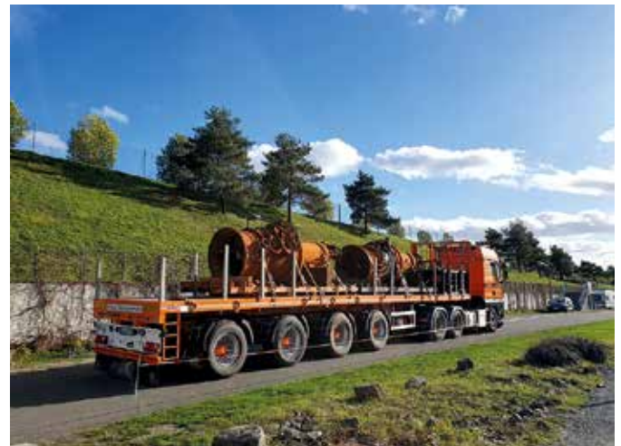
Per Sattelschlepper konnten jeweils zwei Pumpen in das KSB-Werk nach Halle (Saale) zur Wartung gebracht werden. (alle Fotos: Kanupark Markkleeberg)
